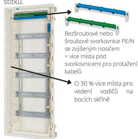
Obr. 1 Rozvodnice KLV v instalačním provedení
