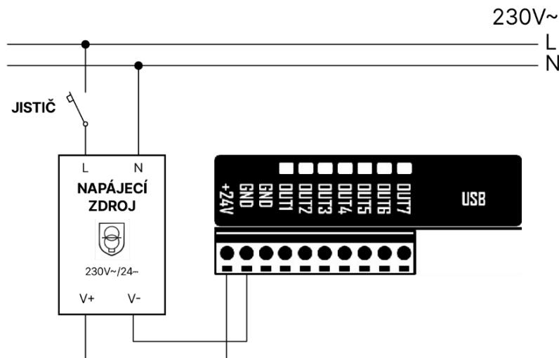
S ohledem na napájení dalších zařízení např. ovládacích relé, doporučujeme zdroj min. 500 mA.
