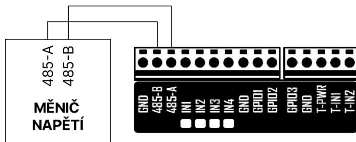
**Poznámky:** V případě měničů Solax Power **X1-HYBRID G4** a **X3-HYBRID G4** připojte NORD Power Genius 3000 pomocí datového kabelu na **COM Port** měniče (pin 4 = A, pin 5 = B).
