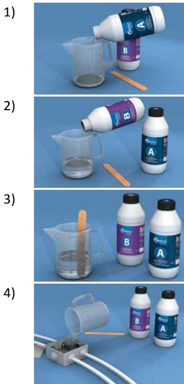
1) Do odměrky (součást dodávky) odlijeme požadované množství gel. hmoty **A** a gel. hmoty **B** (v poměru **1:1**).
